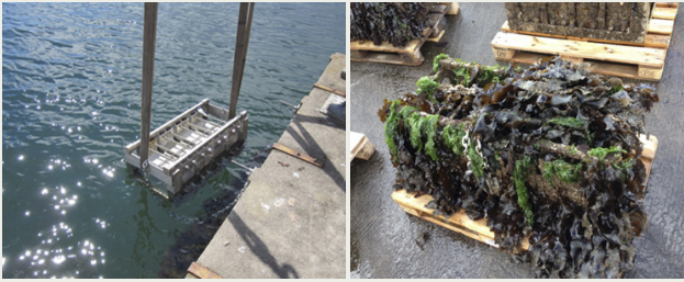
Figur 2. Vänster: nedsänkning av prover placerade i rostfri bur. Höger: upptagna prover efter 15 månaders nedsänkning.
